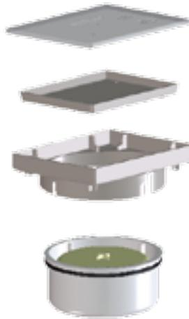
Cadres d'écartement en ABS, réglable en hauteur (7 – 17 mm) permettant l'adaptation aux différentes épaisseurs de carrelages, évacuation de l'eau secondaire en dessous du carrelage
